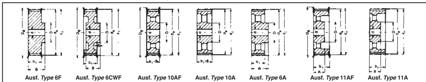
**Type H – Teilung Pitch 12,7 mm für Riemenbreite for belt width 150**
