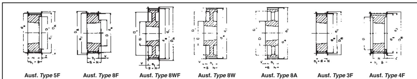
**Type 8M – Teilung Pitch 8 mm für Riemenbreite for belt width 20 mm**
