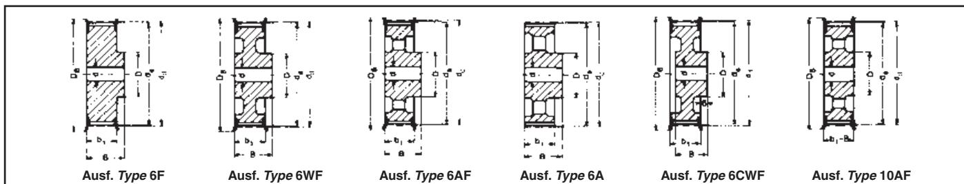
**Type L – Teilung Pitch 9,525 mm für Riemenbreite for belt width 075**
